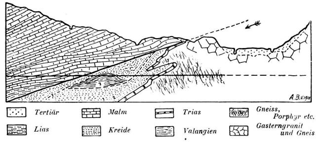
Fig. 4. — Profil durch das « Carbon » im Lötschbergtunnel von A. Buxtorf.
