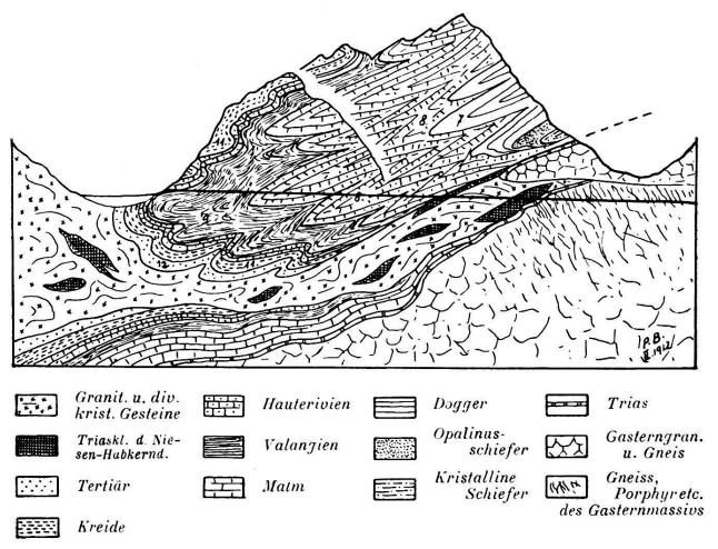
Fig. 5. — Profil durch die Doldenhorngruppe nach Buxtorf und Truninger mit angefahrenem (exotischem) Flysch.
