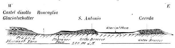
Cl. 4. — Profil durch die pliocänen und diluvialen Ablagerungen bei Balerna.
