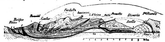
Cl. 10. — Profil par le massif du Simplon, par H. Schardt, avril 1902 à juillet 1903. LÉGENDE: Sk, Schistes lustrés; C, Trias; Sc, Schistes cristallins, amphibolites, etc.; Gn, Gneiss; Gna, Gneiss d'Antigorio.
