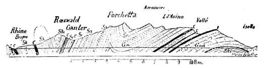
Cl. 5. Profil géologique du massif du Simplon duns l'axe des projets de 1890 et 1893. Légende: Sk, Schistes lustrés; C, calcaire marbre dolomite, gypse, etc. Trias; Sc, Schistes cristallins; Sa, Schistes amphiboliques; Gn., Gneiss. Gn. A. Gneiss d'Antigorio.
