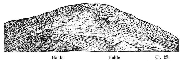
Fig. 10. Querschnitt der fluvioglacialen Terrasse bei Moncherand mit anticlinaler Lagerung (vergl. das Schema Fig. 9). Material: Sand, Kies und Bänder von sandigem Lehm (1) Hohe 18 m., Breite 80 m.
