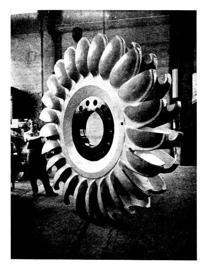
Roue d'une des deux turbines Pelton verticales de 88 000 ch. destinées à la centrale de Cubatâo (Brésil).
