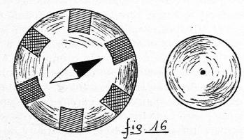
Ces pôles de démarrage sont branchés sur le même courant, mais on intercale un condensateur qui retarde, dans ces pôles, le passage du courant de ¼ de période. On provoque ainsi un champ tournant artificiel.
