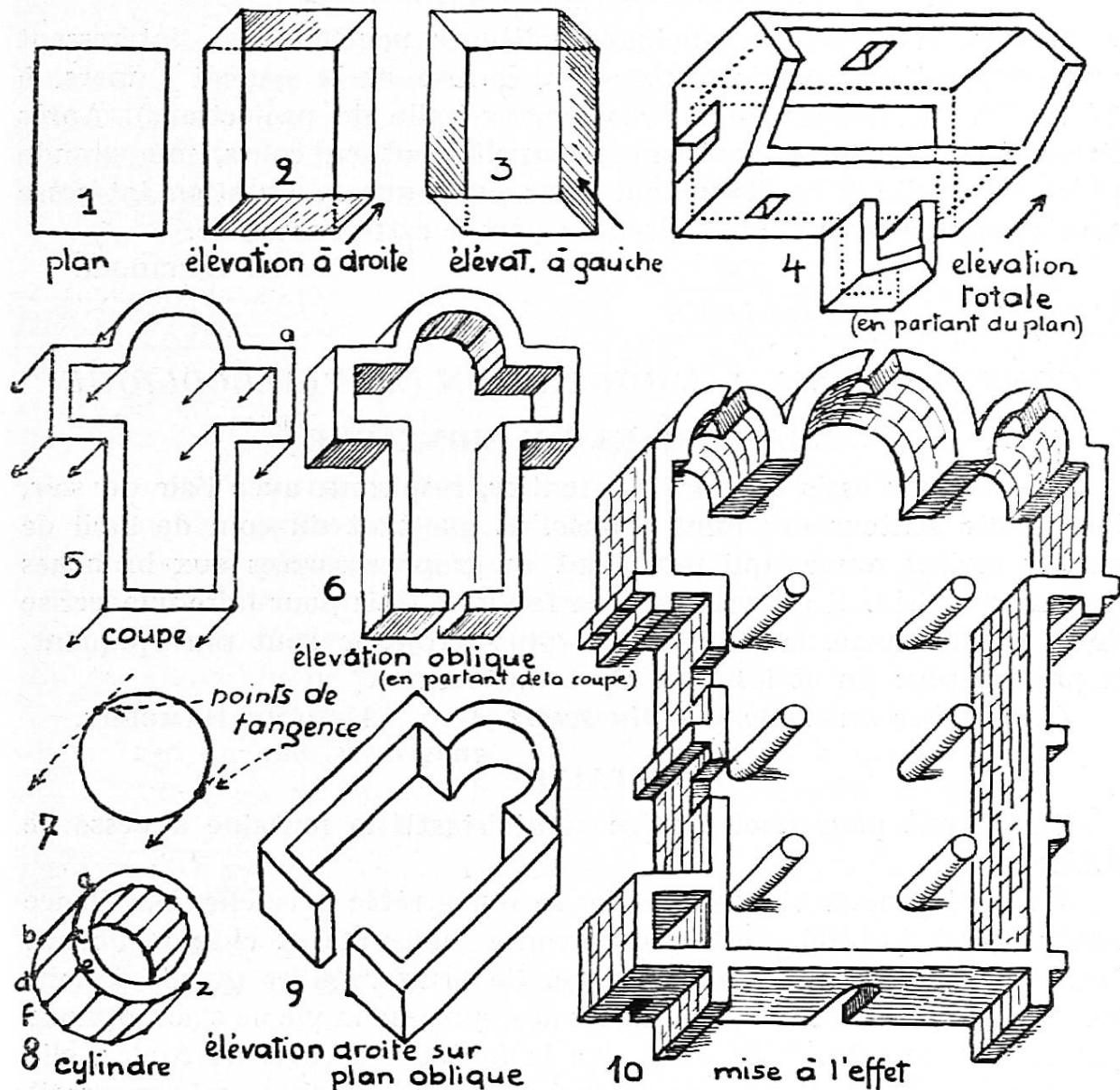
A ceux qui n'admettent pas que des verticales soient tracées *obliquement*, on peut suggérer la solution de la fig. 9, qui consiste à placer la coupe obliquement pour pouvoir descendre les hauteurs *verticalement*. On obtient alors le genre de perspective que nous avions décrit il y a quelques années dans l'*Educateur* sous le titre de *Elévation sur plan*.
