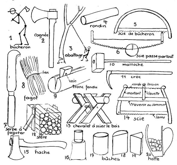
Quand le bûcheron part pour la forêt (fig. 1), il prend une hache à long manche appelée cognée (2). Il coupe ou scie la base des arbres jusqu'à ce que le tronc tienne à peine, puis le fait tomber en tirant sur une corde (3). — Pour scier le tronc en rondins (4) de un mètre de long, il se sert d'une scie très simple formée d'une lame flexible tendue par une branche arquée (5) ou d'une scie passe-partout qui se manœuvre à deux (6). — Les petites branches sont coupées au
