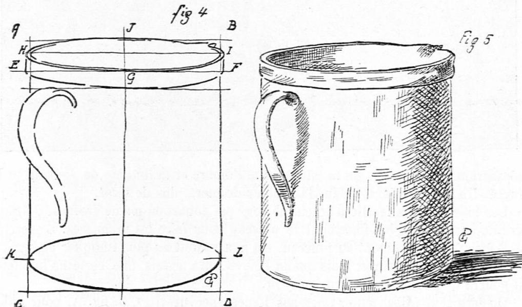
Tracer l'axe et le rectangle enveloppant (fig. 4) A B C D.
