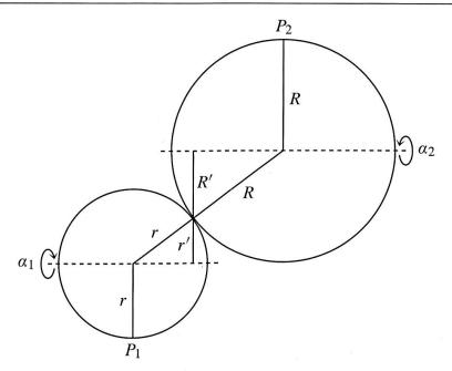
schliesslich  $\alpha_2 = \frac{r}{R}\alpha_1$ . Die in der Aufgabe angegebenen Masse für den Abstand und die Länge der Achsen haben also keinen Einfluss auf das Resultat. (Natürlich müssen diese Masse garantieren, dass sich die Laufkugeln drehen können und dass die grosse Kugel auf ihnen liegt, ohne den Boden zu berühren; das ist aber der Fall.)
