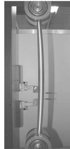
Abb. 16 Knickstab in Zugmaschine unter Last.
