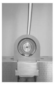
Abb. 15 Gelenklager mit Knickstab unter Last.
