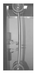
Abb. 16 Knickstab in Zugmaschine unter Last.
