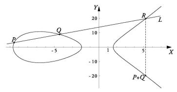
Fig. 2 Addition auf elliptischen Kurven
