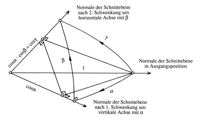
soll ferner die bei allen Lösern nur angetönte Berechnung des Winkels  $\gamma = \angle(\text{Leiste}, \text{Zapfen})$  nachvollziehbar gemacht werden. Sie stellt drei Grosskreisstücke  $\alpha$ ,  $\beta$  und  $\gamma$  auf der Einheitskugel dar, wobei  $\alpha$  und  $\beta$  senkrecht zueinander stehen. Die Normale der
