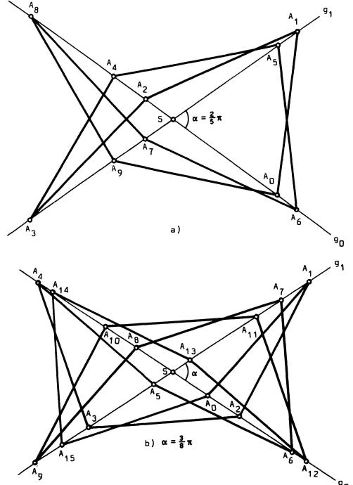
Figur 7. Geschlossene Polygonzüge für  $\alpha = \frac{2}{5}\pi$  und  $\alpha = \frac{3}{8}\pi$ .
