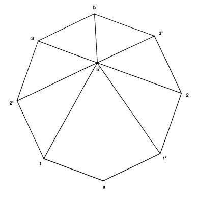
Figur 10. Grundfigur zur Herstellung drehsymmetrischer Ringe.
