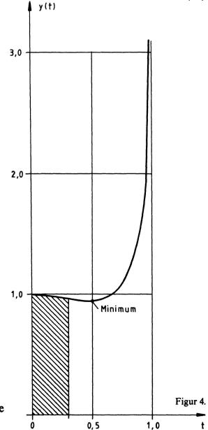
Figur 4 ist zu entnehmen, dass die erzeugende Funktion bei t = 0.5 ein Minimum hat.
