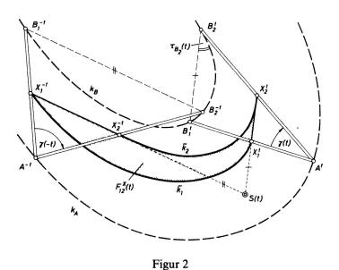
Die Bahnkurvenstücke  $\tilde{k_1}$  und  $\tilde{k_2}$  der Punkte  $X_1$  und  $X_2$  werden nun durch die Strecken  $X_1'X_2'$  und  $X_2^{-i}X_1^{-i}$  zu einer geschlossenen Kurve ergänzt, die bei Durchlaufung in der Reihenfolge  $X_1'X_2'X_2^{-i}X_1^{-i}X_1'$  den orientierten Inhalt
