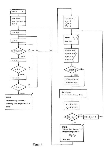
a eingeführt; f dient zur Bestimmung der Kettenlängen, a zur Gewinnung der Mächtigkeit von  $K_4^b$ . Die Dimensionierungsanweisungen im zweiten Kästchen zielen auf eine Umsetzung in die Programmiersprache BASIC ab.
