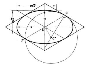
genannten Zwischenpunkte C gehörige Krümmungsradius wird nämlich aus dem Ellipsenzentrum O unter rechtem Winkel gesehen; der Krümmungsmittelpunkt C\* hälftet überdies den zwischen den Achsen befindlichen Normalenabschnitt (Figur). – Beweise für diesen einfachen Sachverhalt lassen sich auf verschiedene Arten führen und dürfen dem Leser überlassen bleiben.
