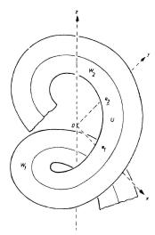
Figur 3. Übergangsfläche  $\ddot{U}$  zwischen einer Wendelfläche  $W_1$  und einer Wendelfläche  $W_2$  (Übergang zwischen  $W_1$  und  $\ddot{U}$  längs der Erzeugenden  $e_1$ , zwischen  $\ddot{U}$  und  $W_2$  längs  $e_2$ ;  $p_1 = 3/\pi = 2p_2$ , n = 1,  $v = \pi/3$ ).
