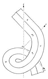
Figur 2. Übergangsfläche  $\ddot{U}$  zwischen einer Wendelfläche W und einer Ebene E (Übergang zwischen W und  $\ddot{U}$  längs der Erzeugenden  $e_1$ , zwischen  $\ddot{U}$  und E längs  $e_2$ ;  $p=3/\pi$ , n=1,  $v=\pi/2$ , c=p).
