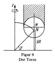
( $\alpha$  läuft von 0 bis  $\pi$ ) entsteht ein Körper, dessen Volumen  $V_2$  nach (3) bestimmt werden kann. Nimmt man zu der schraffierten Fläche noch die Kreisfläche dazu, so ergibt sich bei Drehung ein zweiter Körper. Mit (3) lässt sich auch sein Volumen  $V_1$  ermitteln
