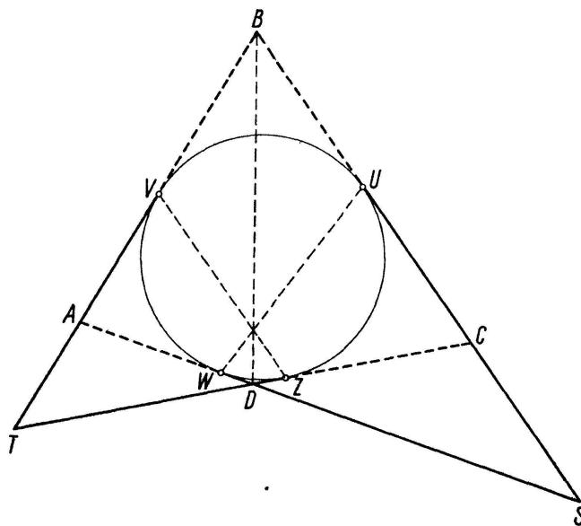
Die Figur wird aufgefasst als Normalprojektion eines räumlichen Gebildes. Der Kreis liegt in der Projektionsebene, die Tangenten sind die Projektionen von Geraden, die den Neigungswinkel  $45^\circ$  und die Spurpunkte  $U$ ,  $V$ ,  $W$ ,  $Z$  besitzen.  $S$ ,  $T$ ,  $D$ ,  $B$  sind die Projektionen echter Schnittpunkte.  $BD$  ist Projektion der Schnittgerade zweier Ebenen mit den Spuren  $UW$  und  $VZ$ . Beweis für die zweite Diagonale  $AC$ , wenn  $T$  eine negative Kote hat.
