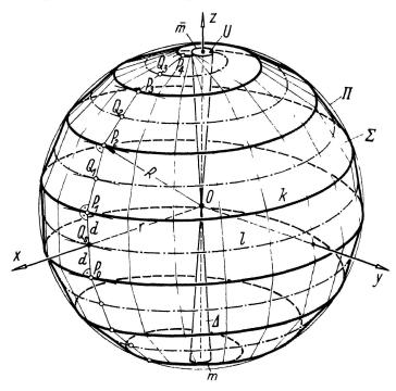
Figur 1 Kugel  $\Pi$  mit Böschungslinie k und eingeschriebenem Torsenstreifen  $\Sigma$ .
