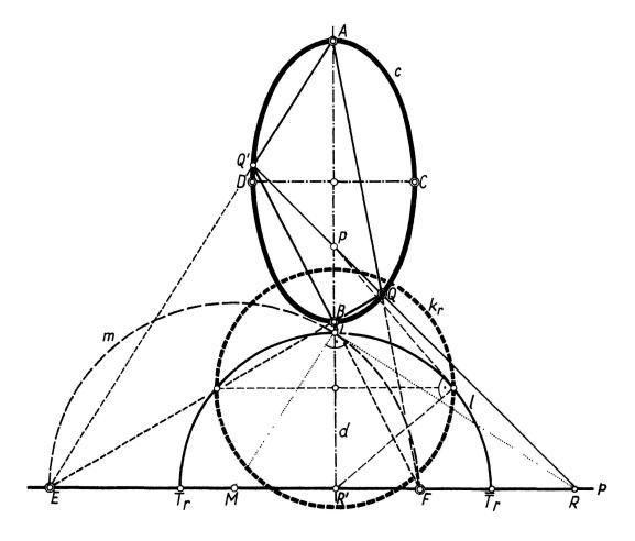
liegen bekanntlich<sup>1</sup>) auf dem durch die Endpunkte des zu p parallelen Durchmessers von  $k_r$  gehenden Kreis l mit der Mitte R' auf p. Die Gerade PQ trifft p in R. Jener Punkt Q' von PQ, der von Q durch P und R harmonisch getrennt wird, liegt dann auch auf dem zu suchenden Kegelschnitt c (Polareigenschaft). Die Hauptscheitel A, B von c, welche aus Symmetriegründen auf dem zu p normalen Durchmesser q von q0 liegen, bestimmen mit q0, q0 ein
