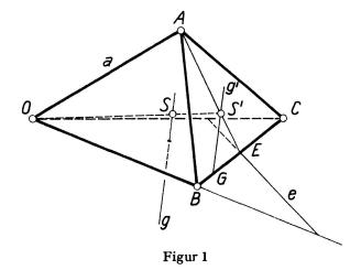
bzw. S' die Gerade a bzw. g' ist, erhält man als Ort des Punktes E die zu a und g' parallele Ebene  $\varepsilon$ , wo auf jeder gemeinsamen Transversalen von a und g' die obige Proportion der Entfernungen für den Schnittpunkt mit der Ebene und die beiden Fusspunkte gilt.
