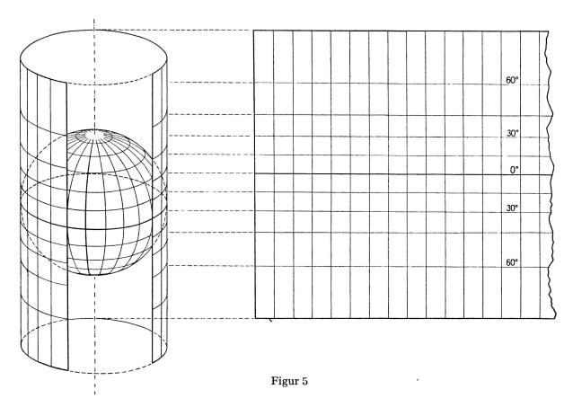
abnehmen.» Interpretiert man diese Abbildungsart mathematisch, so können wir aus Figur 5 entnehmen, dass der Abstand der Meridiane mit wachsender geographischer Breite  $\varphi$  auf der Kugel mit dem Radius R proportional dem  $\cos \varphi$  abnimmt. Da dieser Abstand aber in der Mercator-Projektion unverändert bleibt, so nimmt das Vergrösserungsverhältnis unserer Abbildung mit zunehmender Breite im Verhältnis  $1:\cos \varphi$  zu, also gilt die Beziehung
