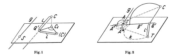
Geraden CQ' um ihre orthogonale Projektion  $C_1Q'$  in die Bildebene (Figur 1). 2. Dann zeichnet man einen Kreis k, den sogenannten Teilungskreis, um Q' mit dem Halbmesser l (Figur 2). 3. Endlich projiziert man den Punkt A' von einem beliebigen Punkt T des Teilungskreises k auf die durch S gehende und zu Q'T parallele Gerade. So ergibt sich ein neuer Punkt  $A^*$ ; der gesuchte Abstand ist gleich der Länge der Strecke  $A^*S$ .
