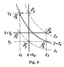
wir drei beliebige Gewebekurven aus, etwa die Geraden  $x=x_0$ ,  $y=y_0$  und die Hyperbel  $x\ y=z_0$  (Figur 9). Durch den auf der Geraden  $y=y_0$  frei wählbaren Punkt  $P_1$  legen wir die beiden andern Gewebekurven und führen diese Konstruktion im Gegenuhrzeigersinn weiter. Es soll hernach gezeigt werden, dass die Gerade  $x=x_1$  durch  $P_1$  und die Gerade  $y=y_2$  durch  $P_5$  sich in einem Punkt  $P_6$  auf der Hyperbel  $z=z_0$  schneiden.
