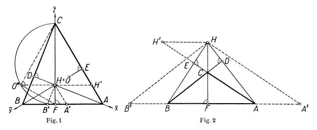
(Fig. 1). Das Verkürzungsverhältnis auf der z-Achse beträgt dann  $v_z = C\overline{O}/CO^* = CO^*/CF$  und das Quadrat  $v_z^2 = C\overline{O}/CF$ . Analog findet man  $v_y^2 = B\overline{O}/BE$  und  $v_x^2 = A\overline{O}/AD$ . Da aber  $v_x^2 + v_y^2 + v_z^2 = 2$  ist, ist der Satz bewiesen; denn  $\overline{O}$  ist mit dem Höhenschnittpunkt identisch.
