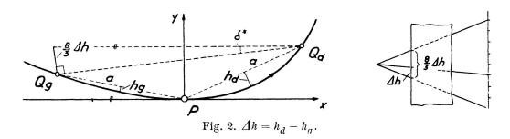
Pour développer cette idée par le calcul, on prendra un système de coordonnées x, y ayant pour origine le point P, de telle manière que l'axe Px positif coïncide avec la tangente (orientée) en ce point. — Soit
