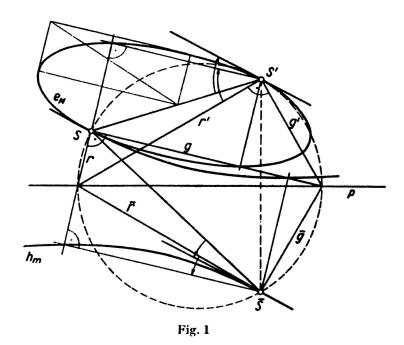
Soient f et f' les deux faisceaux projectifs, S et S' leurs sommets. Supposons que l'un des faisceaux, f par exemple, soit fixe, et que l'autre f' tourne autour de son sommet S'; dans toutes les positions de f', les deux faisceaux de droites engendrent une conique.
