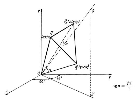
Durch zweimalige Drehung dieses Punktes um  $120^{\circ}$  um die Achse O.S. (1/1/1) des ersten Oktanten erhalten wir zwei weitere Punkte  $P_2$  und  $P_3$ . Wie man leicht sieht, entspricht diese Drehung einer zyklischen Vertauschung der Koordinaten des angenommenen Punktes; somit sind die gedrehten Punkte  $P_2$  (Y/Z/X) und  $P_3$  (Z/X/Y).
