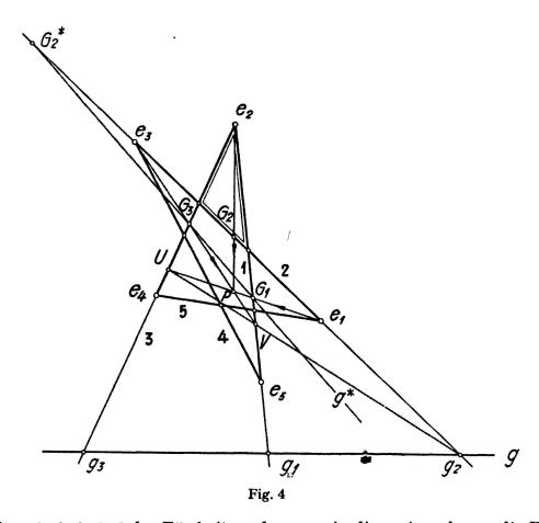
Den Seiten 1, 2, 3, 4, 5 des Fünfseits ordne man in dieser Anordnung die Punkte  $e_1$ ,  $e_2$ ,  $e_3$ ,  $e_4$ ,  $e_5$  zu. Die vier Punkte auf jeder Geraden i des Fünfseits sollen nun als die erzeugenden Elemente einer hyperbolischen Involution aufgefaßt werden, derart aber, daß zugeordnete Paare nicht ineinanderliegen.
