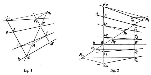
A'B'. Mener une des diagonales, A'B par exemple, du trapèze AA'B'B. Par L, tracer LM parallèle à a, puis ML' parallèle à b (intervertir l'ordre des parallèles à a et b, si l'on choisit la diagonale AB'). LL' appartient au faisceau considéré. On a, en effet:
