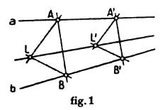
Soient a et b deux droites données d'intersection I inaccessible, et L le point donné par lequel doit passer un rayon du faisceau de sommet I.
