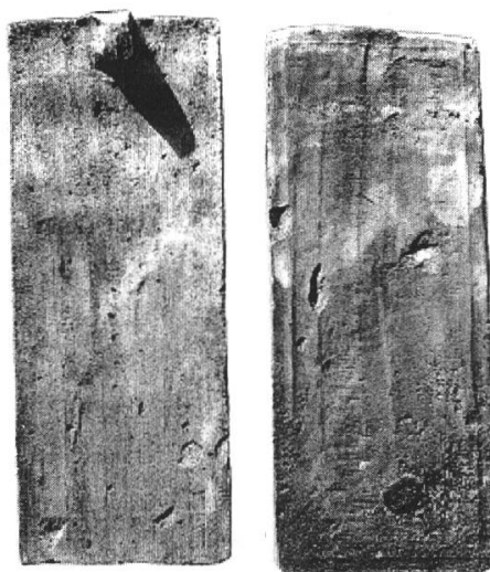
Fig. 2. Tuile façonnée «à l'allemande». La surface extérieure montre l'empreinte d'une toile grossière (a) (MHA VD 33/21)
