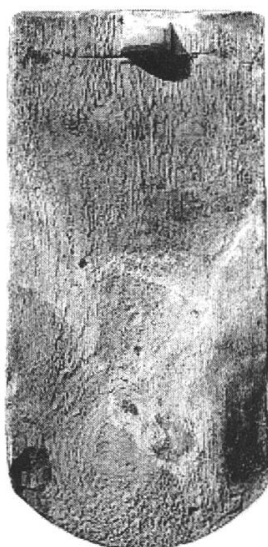
Fig. 3. Négatif de la planchette ayant servi de fonce visible sur la surface intérieure d'une tuile moulée «à l'allemande» (MHA VD 8/14)
