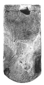
Fig. 3. Négatif de la planchette ayant servi de foncet visible sur la surface intérieure d'une tuile moulée «à l'allemande» (MHAVD 8/14)
