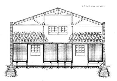
Fig. 6. — Coupe sur l'entrepôt et les citernes à vin de la maison J. Latrille & Fils, dans le port de Bordeaux. Projet et réalisation en 1901. Louis Goguel, ingénieur; L. Beaudin, architecte. Conçues comme des poutres creuses, les cuves contiennent 20 000 hectolitres. Dès 1900, nombreux sont en Gironde et dans le sud-ouest les producteurs qui placent leurs récoltes dans le béton armé.
