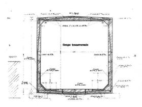
Fig. 7. — Coupe transversale sur le canal hydraulique du Simplon. Samuel de Mollins, ingénieur; M<sup>me</sup> A. Ferrari, responsable du chantier. Projet et réalisation en 1898. Cet aqueduc de trois kilomètres alimentait les génératrices de la centrale de Brigue durant la perforation du tunnel (1898-1922).
