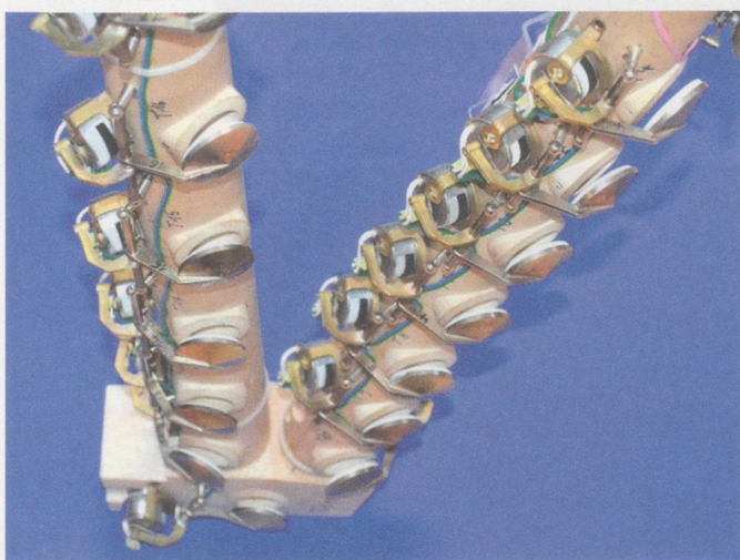
In Halbtonabständen realisierte Tonlochklappenantriebe. Foto: Daniel Debrunner
