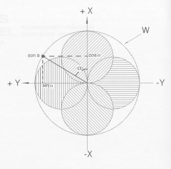
l'amplitude de s. Enregistrons enfin l'amplitude totale du son avec un microphone omnidirectionnel (représenté par le cercle w dans la fig. 1). Le codage de l'information spatiale du son s dans deux dimensions se calcule alors à l'aide des formules suivantes :
