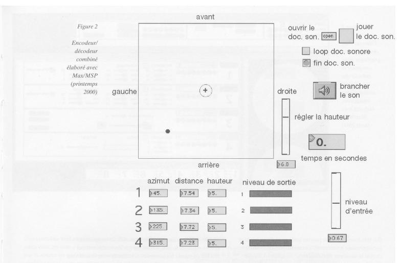
Le carré de gauche représente une salle vue d'en haut. Le point noir montre la position d'un son dans le plan horizontal, et peut être déplacé avec la souris. Les curseurs à droite du carré permettent de fixer la position en hauteur du son. Les champs sous le carré permettent de déterminer la position de chaque haut-parleur (quatre, dans le cas présent); le programme calcule le décodage optimal et compense au besoin l'inégalité de distance du haut-parleur par rapport au centre.
