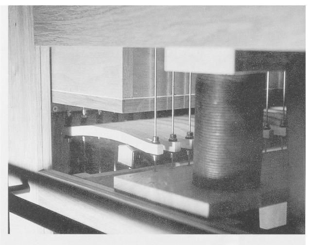
sächlich Clavichord spielen kann! Mit dem Winddruck II und dem Kegelübersetzungsverhältnis kann ausserdem die Intensität der Wirkung individuell der Anzahl der gezogenen Register und der jeweiligen Situation angepasst werden.
