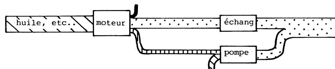
Schématiquement, les pertes sont indiquées par les parties sombres des dessins (ordre de grandeur respecté). Dans les trois cas, l'énergie thermique obtenue est transportée finalement par l'eau chaude (ou l'air, dans le système «centrale thermique»).
