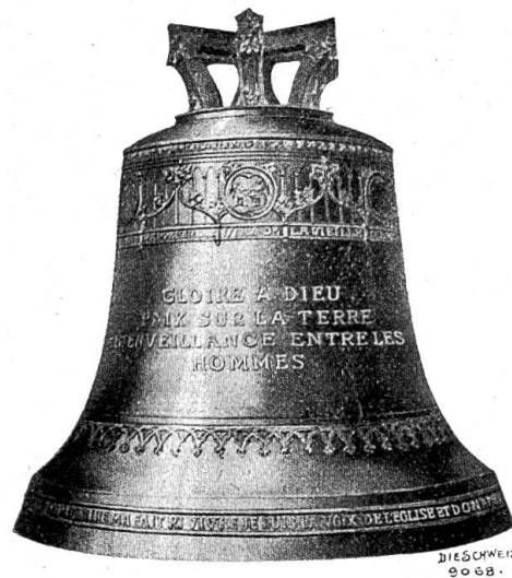
Glocke „La Clémence“ in G (Gewicht 6238 kg) in der Cathédrale de St. Pierre, Genf aus der Gießerei H. Rüetschi in Aarau.
