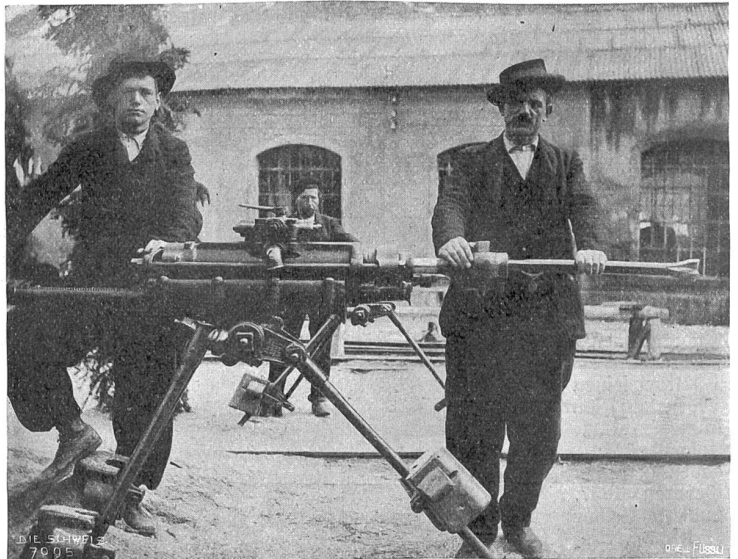
Bohrmaschine durch komprimierte Luft getrieben. Phot. W. Zollinger, Zürich.
