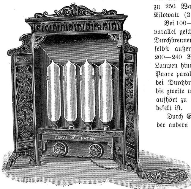
Jeder Ofen (ausgenommen 422a und 433) ist mit 4 Lampen ausgestattet, von denen je 2 zusammen durch einen der beiden vorn befindlichen Schalter geschaltet werden, so daß auch mit der halben (oder bei 1½ Kw. mit ein drittel bezw. zwei dritteln, da hier an einem Schalter 2 Lampen zu 250 Watt, am andern 2 Lampen zu 500 Watt hängen Stromstärke geheizt werden kann. Nr. 422a und 433 haben nur 2 Lampen mit einem Schalter und sind demgemäß nicht regulierbar.
