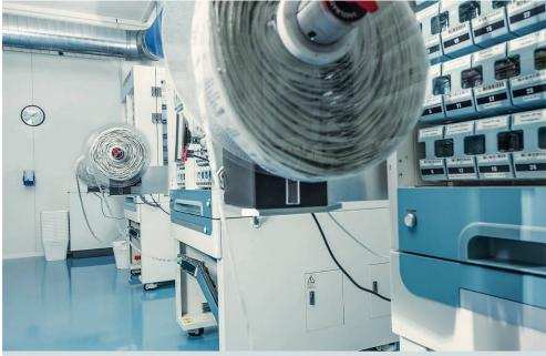
Die Produktionsmaschinen verpacken pro Monat über eine Million Pillen in Plastikbeutel, die pro Bestellung aneinanderhängen und auf Spulen aufgerollt werden. Fotos: Medifilm
