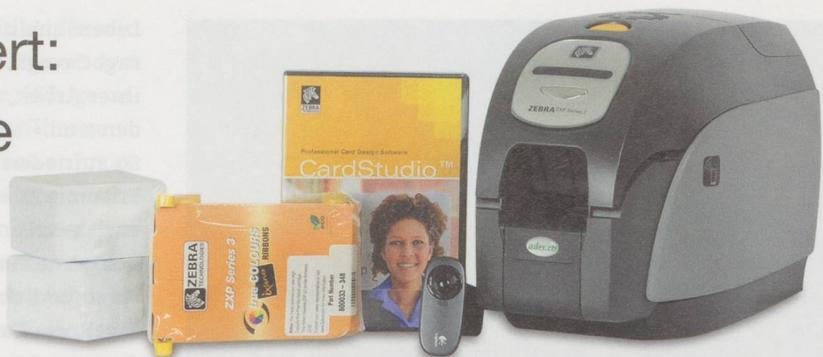
Beim Thermosublimations-Verfahren kommen Thermotransfer-Farbbänder nach dem CMYK-Farbsatz zum Gebrauch. Dabei wird die zu bedruckende Karte mehrmals bei der jeweiligen Farbe am Druckkopf vorbeigeführt. Jedoch nur edge-to-edge, randabfallender Druck ist bei dieser Methode nicht möglich. Die Farbe wird in Abstufungen direkt auf die Karte aufgedampft (sublimiert). Damit lassen sich hohe Farbtiefen mit bis zu 16 Mio. Farben auf der Karte erreichen.
