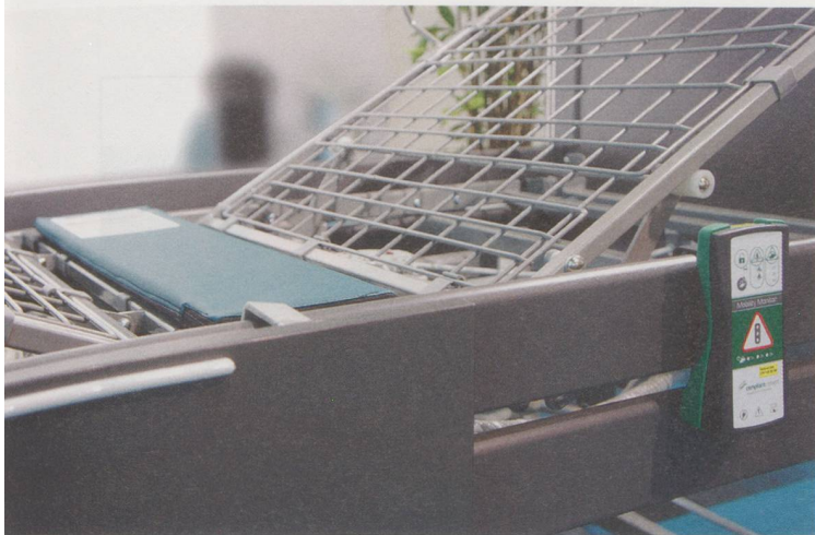
Die Messeinheit des Mobility Monitors wird unter der Matratze fixiert und mit dem Bediengerät verbunden.
