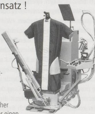
Dieser Finisher verfügt über einen frequenzgesteuerten Gebläsemotor, der es erlaubt, die für jedes Teil und jedes Material optimale Gebläseenergie zu entfalten !
