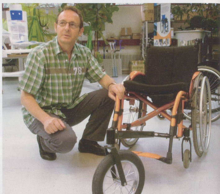
Luigino Trebuchchi demonstriert, wie einfach sich ein gewöhnlicher Rollstuhl mit einem Zusatz zu einem Cross-Modell umfunktionieren lässt.
