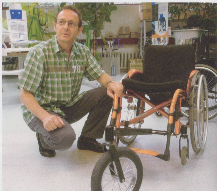
Luigino Trebucchi demonstriert, wie einfach sich ein gewöhnlicher Rollstuhl mit einem Zusatz zu einem Cross-Modell umfunktionieren lässt.
